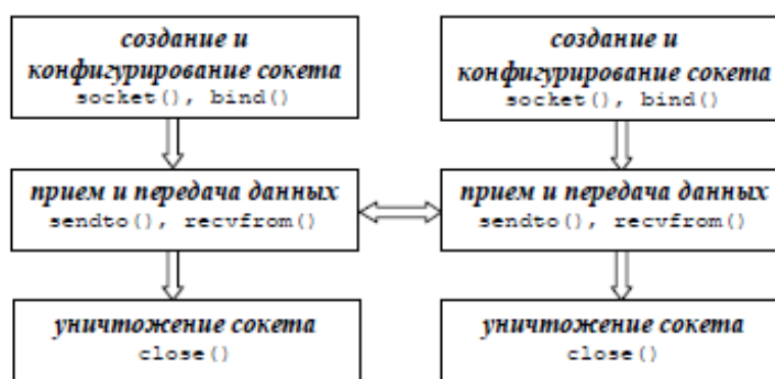
Рисунок 8 – Схема работ с сокетами без установления виртуального канала
