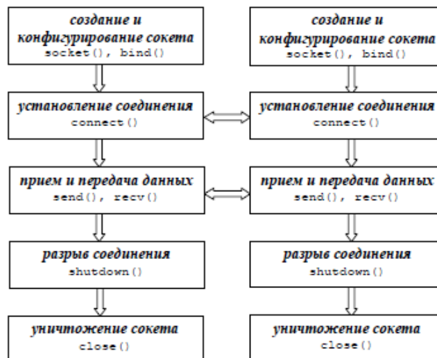
Рисунок 6 – Схема работы с сокетами с установлением виртуального канала
